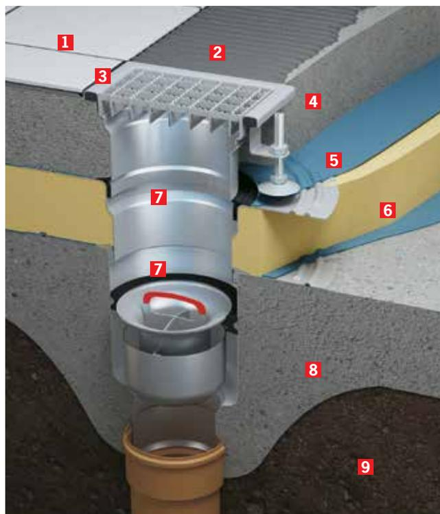
**Vgradnja enodelnega požiralnika s
