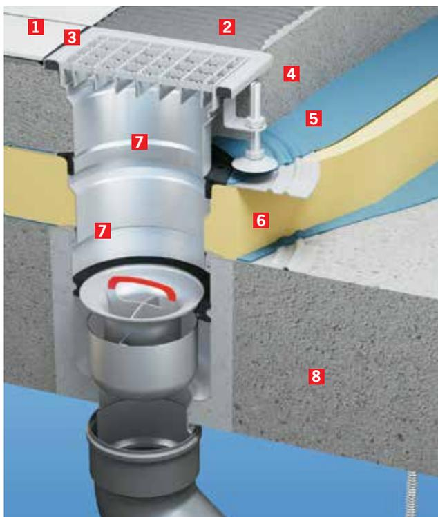
**Vgradnja višinsko nastavljivega požiralnika s prirobnico za hidroizolacijo v temeljno betonsko ploščo**
