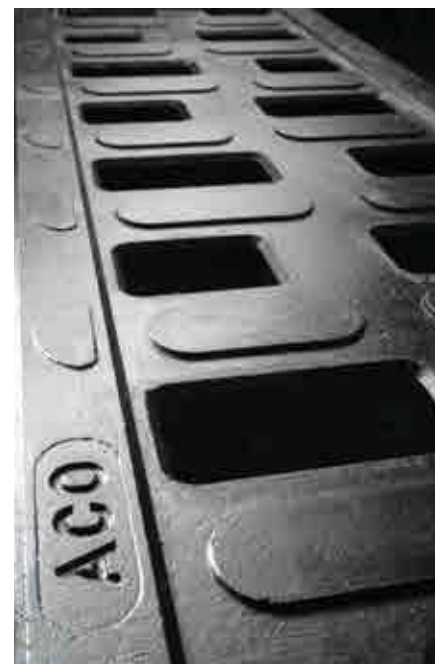
ACO Monoblock kanalete se izdelujejo v večih višinah - za polaganje v kaskadnem padcu.
