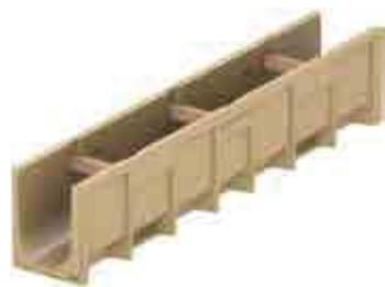
**Sistem 1000 kanalete** iz polimernega betona svetle širine 12,5 cm, z leseno distančno letvijo in povišano stranico 40 mm za travnato površino.
