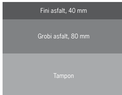
Standardna konstrukcija vozišča v Evropi.
