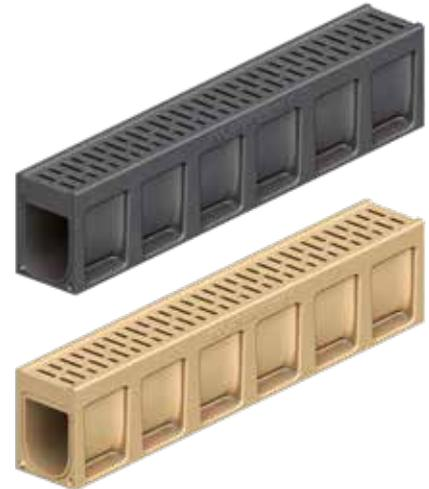
**Monoblock PD100 V revizijski element**, monolitna izvedba iz polimernega betona, v natur barvi, brezvijačno pritrjena litoželezna pokrivna rešetka EN-GJS, predoblikovan ali narejen iztok na dnu za vertikalni iztok DN100, bočna predoblikovanja za kotne, križne ali T - povezave. Razred obremenitve D400 kN po SIST EN 1433.
