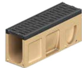
**Monoblock PD100 V zbiralnik**, iz polimernega betona z litoželezno pokrивно rešetko, iztok DN100/DN150, vedro za umazanijo. Razred obremenitve D400 kN po SIST EN 1433.
