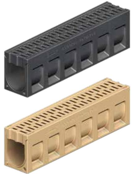
**Monoblock PD150 V revizijski element**, monolitna izvedba iz polimernega betona, v natur barvi, brezvijačno pritrjena litoželezna pokrivna rešetka EN-GJS, predoblikovanje za vertikalni iztok DN150 (se izbije na gradbišču), bočna predoblikovanja za kotne, križne ali T - povezave. Razred obremenitve D400 kN po SIST EN 1433.
