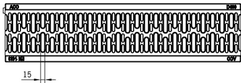
**Monoblock PD200 V revizijski element**, monolitna izvedba iz polimernega betona, v natur barvi, brezvijačno pritrjena litoželezna pokrivna rešetka EN-GJS, predoblikovan ali narejen iztok na dnu za vertikalni iztok DN150, bočna predoblikovanja za kotne, križne ali T - povezave. Razred obremenitve D400 kN po SIST EN 1433.
