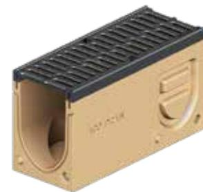
**Monoblock PD150 V zbiralnik**, iz polimernega betona, brezvijačno pritrjena litoželezna pokrivna rešetka EN-GJS, iztok DN150 z integriranim tesnilom, vedro za umazanijo. Razred obremenitve D400 kN po SIST EN 1433.
