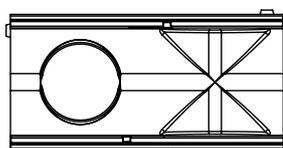
**Monoblock PD200 V zbiralnik**, iz polimernega betona z litoželezno pokrivno rešetko, iztok DN150, vedro za umazanijo. Razred obremenitve D400 kN po SIST EN 1433.
