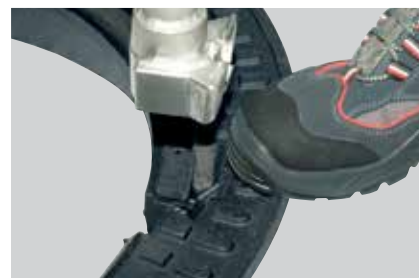
Ko je sproščena potegnite pripravo navzgor iz okvirja.
