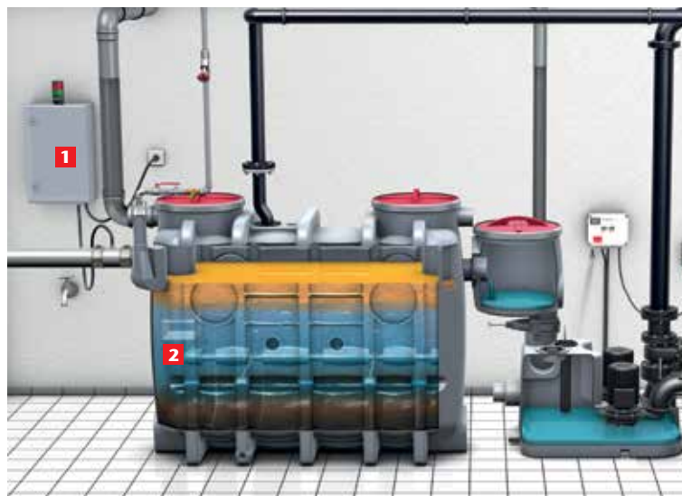
(1) Nevtralizator vonjav za izločevalce maščob (2) Izločevalac maščob iz polietilena, osnovna izvedba (stopnja opremljenosti 1)
