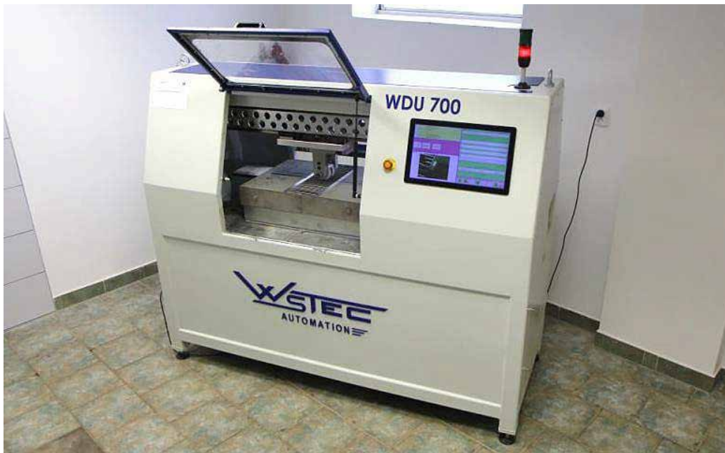
Slika 5 – WSTEC oprema, razvita za testiranje mehanske izpostavljenosti
