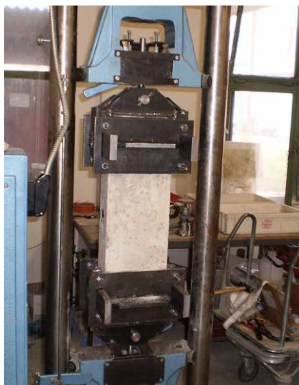
Slika 8 – Detajl opreme za testiranje natezne sile
