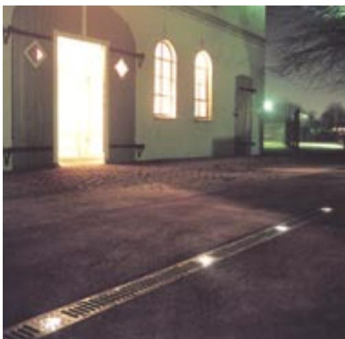
LED Lightspot je način osvetlitve linijskih požiralnikov in se lahko vgradi do razreda obremenitve D 400 kN.
