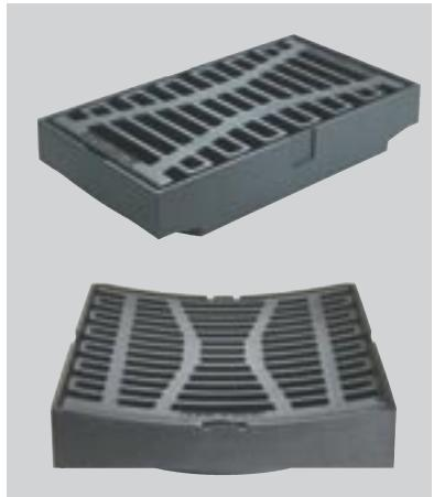
Multitop® vtočne rešetke za kanalizacijske jaške izdelujemo v ravni ali muldasti obliki, v dveh standardnih dimenzijah 300 x 500 in 500 x 500 mm. Izdelane so skladno s SIST EN 124 in namenjene za vgradnjo do obremenitvenega razreda D 400 kN.
