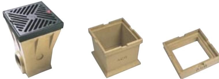
Dvoriščni požiralnik iz polimernega betona z litoželeznim okvirjem in litoželezno brezvijačno Pointlock® pritrjeno pokrivo rešetko, za razred obremenitve do B 125 kN.
