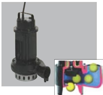
SAT potopne črpalke, bočno postavljen Vortex rotor omogoča popolnoma prost presek. SAT črpalke so zato primerne za vlaknaste in zelo umazane vode.
