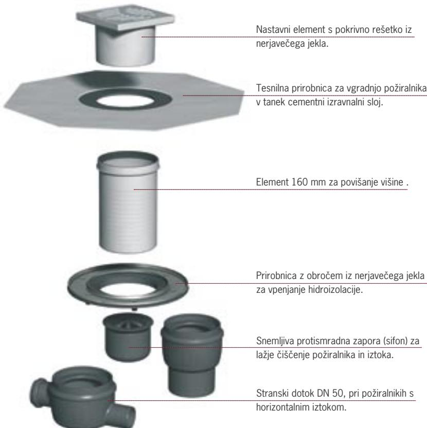
Talni požiralniki iz umetnih mas, so del modulnega sistema ACO talnih požiralnikov, ki omogoča veliko število kombinacij v nominalnih dimenzijsah DN 50, DN 70 in DN 100. Za ta program se lahko uporablajo tudi pokrovne rešetke WAL-SELECTA.
