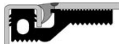
Primer vgradnje: pravilno tesnenje med vinilno talno oblogo in požiralnikom, onemogoča prodor vode v talno konstrukcijo
