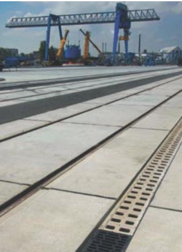
ACO DRAIN® Monoblock je monolitni linijski požiralnik, izdelan iz enega kosa, namenjen vgradnji za obremenitve C 250 do F 900 kN.
