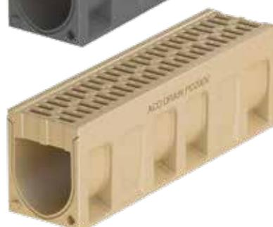
**Monoblock PD200 V revizijski element**, monolitna izvedba iz polimernega betona, v natur barvi, brezvijačno pritrjena litoželezna pokrivna rešetka EN-GJS, predobljovan ali narejen iztok na dnu za vertikalni iztok DN150, bočna predobljovanja za kotne, križne ali T - povezave. Razred obremenitve D400 kN po SIST EN 1433.
