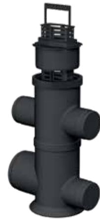
**Xtradrain X100 zbiralnik** iz polimernega betona, z integriranim tesnilom na iztoku. Zaščitni rob iz umetne mase ali vroče cinkanega jekla, PVC vedro za grobe nečistoče
