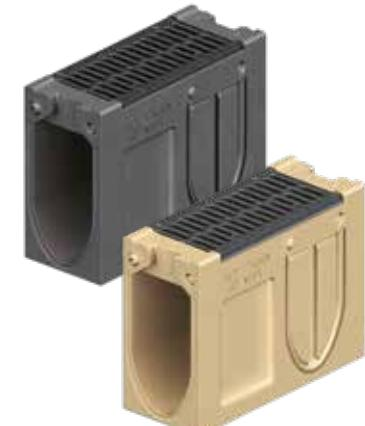
**Monoblock RD150 V zbiralnik**, iz polimernega betona, z litoželezno pokrivno rešetko, iztok DN150/DN200, vedro za umazanijo. Razred obremenitve F900 kN po SIST EN 1433.
