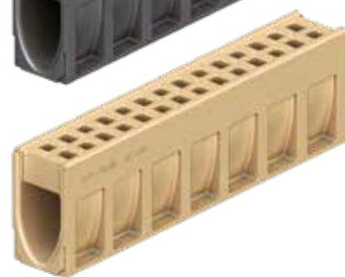
**Monoblock RD100 V revizijski element**, monolitna izvedba iz polimernega betona, v natur barvi, brezvijačno pritrjena litoželezna pokrivna rešetka EN-GJS, predoblikovan ali narejen iztok na dnu za vertikalni iztok DN100, bočna predoblikovanja za kotne, krizne ali T - povezave. Razred obremenitve D400/F900 kN po SIST EN 1433.
