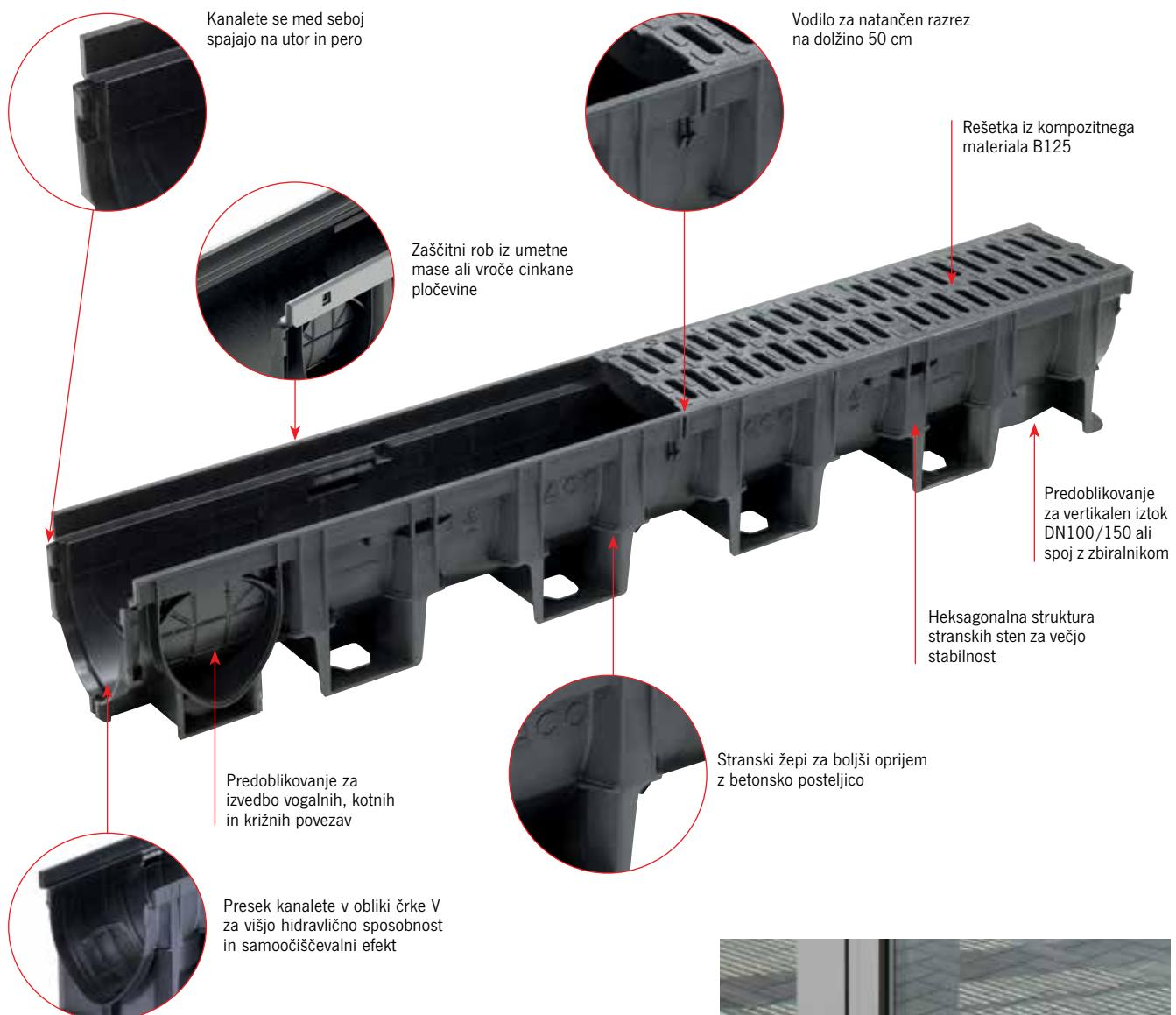
Kanalete ACO Xtradain lahko kombiniramo z vsemi pokravnimi rešetkami iz programa Multiline in pokrovi z rego iz programa SlotTop do obremenitvenega razreda D400 kN.
