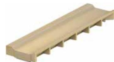
**Sistem 5000-2 nizke mulde** iz polimernega betona, svetle širine 18,5 cm, za krožne steze po DIN 18035-T3 z utorom za sintetične obloge, sidra za betoniranje.
