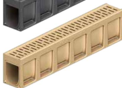
**Monoblock PD100 V revizijski element**, monolitna izvedba iz polimernega betona, v natur barvi, brezvijačno pritrjena litoželezna pokrivna rešetka EN-GJS, predoblikan ali narejen iztok na dnu za vertikalni iztok DN100, bočna predoblikanja za kotne, križne ali T - povezave. Razred obremenitve D400 kN po SIST EN 1433.
