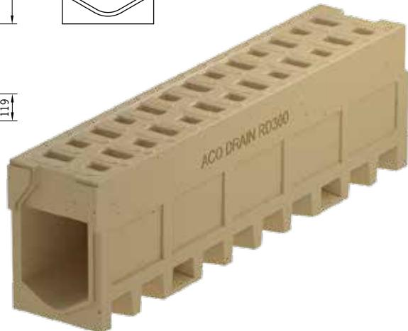
**Monoblock RD300 reviziji element**, monolitna izvedba iz polimernega betona, v natur barvi, brezvijačno pritrjena litoželezna pokrivna rešetka EN-GJS, predoblikovan ali narejen iztok na dnu za vertikalni iztok DN300, bočna predoblikovanja za kotne, križne ali T - povezave. Razred obremenitve F900 kN po SIST EN 1433.
