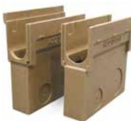
Proizvodi ACO SPORT so razdeljeni v nekaj različnih sistemov. Sistemi 1000 in 1500 so med seboj kompatibilni in namenjeni za linijsko odvodnjavanje okoli notranjega kroga atletske steze. Elementi so lahko ravni ali v radiju 36,5 m. Na razpolago sta še posebna radija 24 m in 48 m. Sistem 1000 sestavljajo kanalete z U presekom, namenjene za pokrove iz umetne mase s stranskim dotokom.
