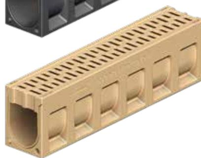
**Monoblock PD150 V revizijski element**, monolitna izvedba iz polimernega betona, v natur barvi, brezvijačno pritrjena litoželezna pokrivna rešetka EN-GJS, predobljokovanje za vertikalni iztok DN150 (se izbije na gradbišču), bočna predobljokovanja za kotne, križne ali T - povezave.
