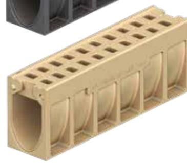
**Monoblock RD150 V revizijski element**, monolitna izvedba iz polimernega betona, v natur ali antracit barvi, brezvijačno pritrjena litoželezna pokrivačna rešetka EN-GJS, predoblikovan ali narejen iztok na dnu za vertikalni iztok DN100, bočna predoblikovanja za kotne, križne ali T - povezave. Razred obremenitve F900 kN po SIST EN 1433.
