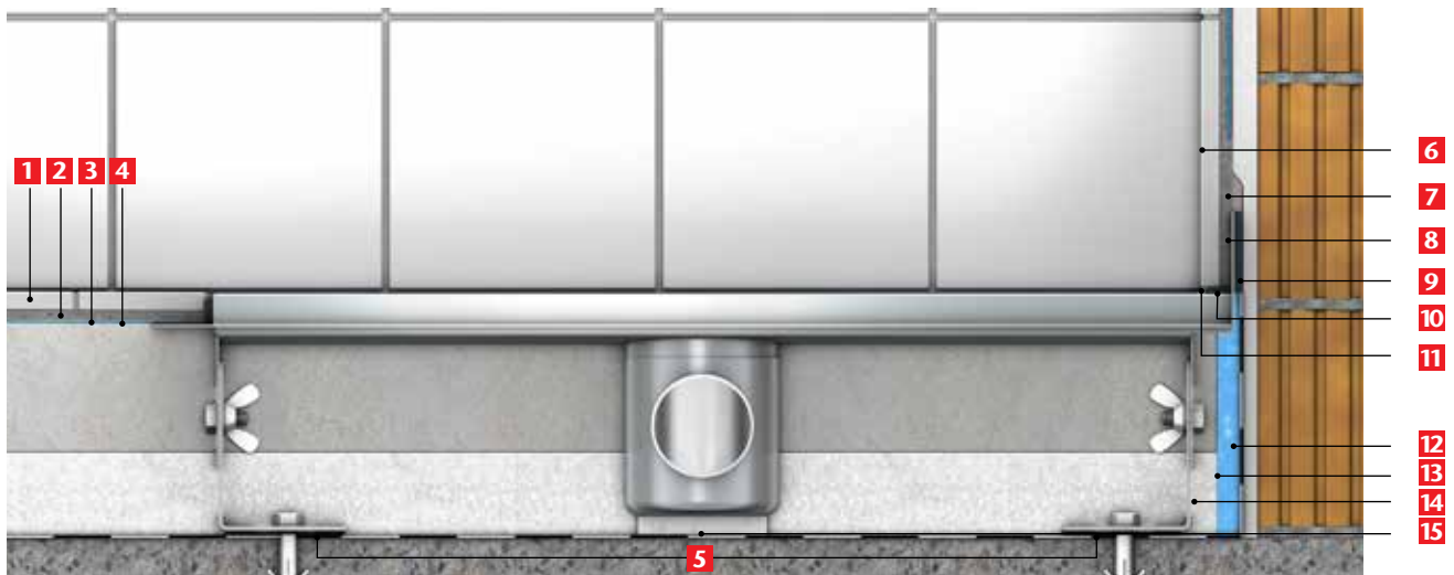
Prerez kanalete od spredaj, predlog vgradnje z zaščito proti udarnemu zvoku
