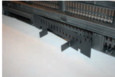
Aufstecken des Anschlussэлемэnts auf die Zapfen
