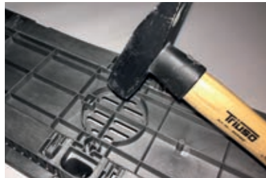
Ausschlagen der Bereiche für den Einsteckstutzen
