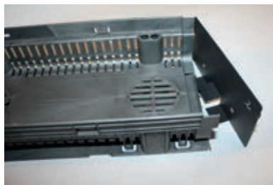
Ansetzen der Stirnwand
