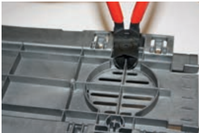
Durchtrennen der vier Stege von unten
