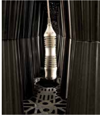
Cevna kamera se spusti navpično v notranjost
