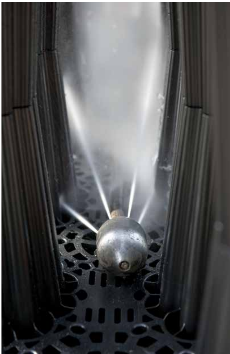
Oprema za čiščenje z glavo za izpiranje
