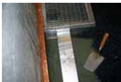
Preizkus pri stransko položeni slepi kanalet (brez izreza v nastavku)
