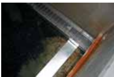
Preizkus s stransko položeno slepo kanalet (brez izreza v kanalet)
