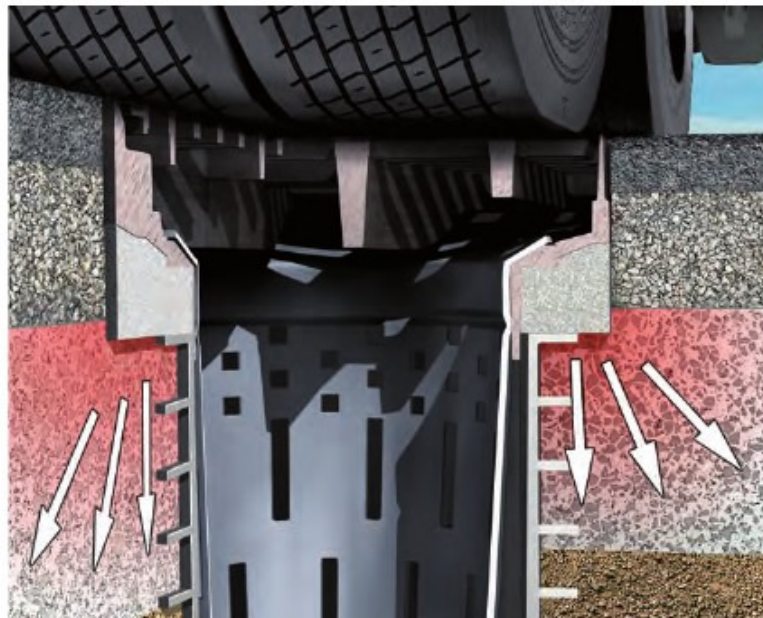
Na spodnji strani okvirja Combipoint PP nastavka z rešetko se nahaja obroč iz litega železa, katerega se vstavi v plastičen spodnji del. Preko tega obroča se voda učinkovito steka v požiralnik.
