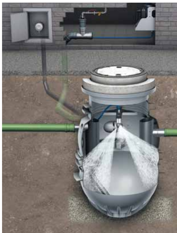
Primer vgradnje izločevalca NG4 z nastavkom za povišanje in pokrovom razreda obremenitve B125
