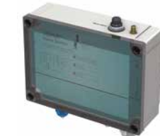
Avtomatizirano signaliziranje z GPS povezo-vo in SMS opozorilom
