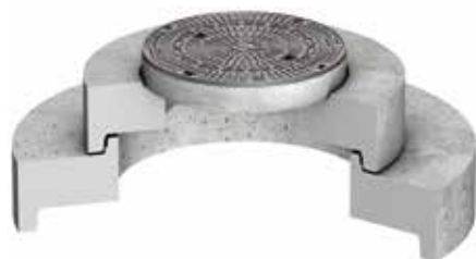
Zgornji del izdelan iz armiranega betona, s prehodno ploščo in pokrovom iz litega železa, razred obremenitve D 400, po SIST EN 124
