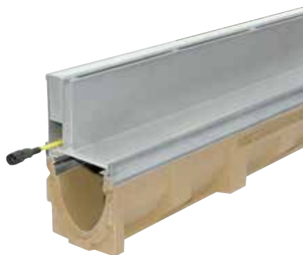
ACO Sideline je sestavljen iz kanale za odvodnjavanje ACO Multiline V100 S, pokrova z rego iz nerjavečega jekla in 29 mm široke LED svetilke podjetja INSTA Elektro GmbH.
