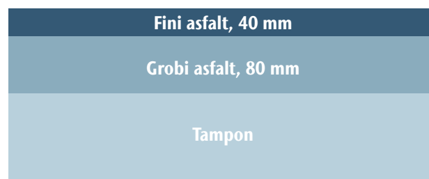
Standardna konstrukcija vozišča v Evropi.
