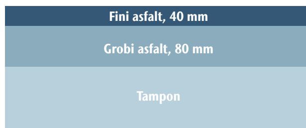
Standardna konstrukcija vozišča v Evropi.
