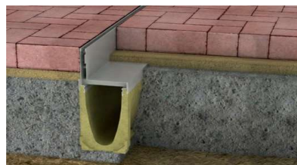
Vgrajena kanaleta z nastavkom z rego
